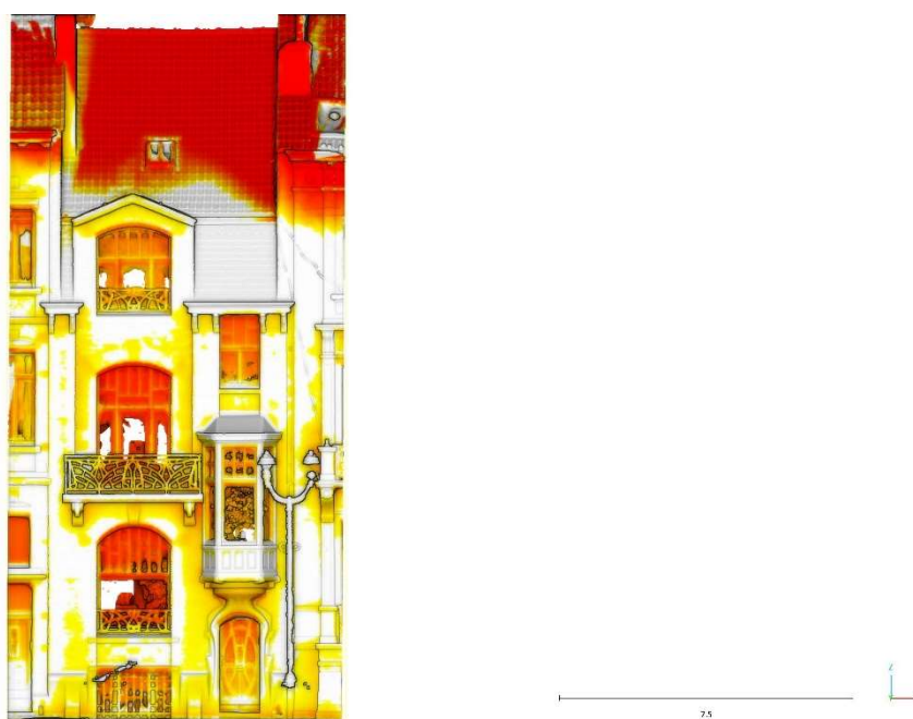
Figure 10. Autre exemple de reconstruction par photogrammétrie à partir des images thermiques prises par drone
